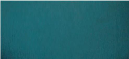
*Der gezielte Aufbau der Passivschicht bis hin zu definierten Dicken erzeugt Lichtinterferenzen, welche die behandelten Oberflächen farbig erscheinen lassen.*
